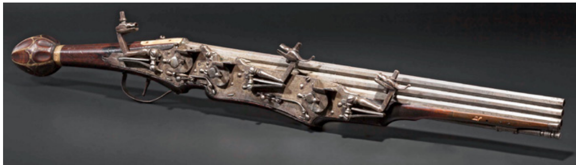
11) Pistola a ruota con tre canne sovrapposte. Baviera (?), Pistola tedesca a tre canne, fine XVI secolo, Collezione privata.
