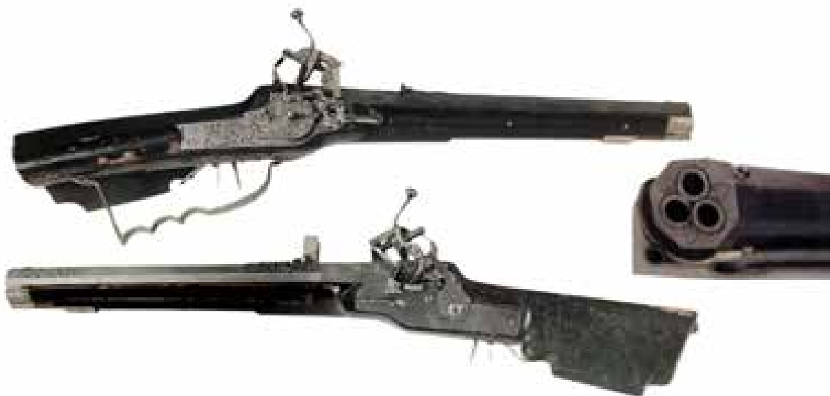
15) Dettagli dell'archibuso con tre canne tonde saldate all'interno di una canna quadra. Germania (Augsburg?) fine XVI – inizio XVII secolo. San Pietroburgo, Museo d'Artiglieria, inv. 18/349.
