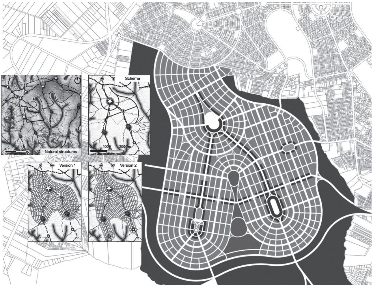
Fig. 2 - Fasi di progettazione del tracciato: dalla strutturazione naturale (sinistra) alle successive versioni basate su uno schema di strutture antropiche coerenti col sito; versione finale (destra) (elaborato dagli autori).
