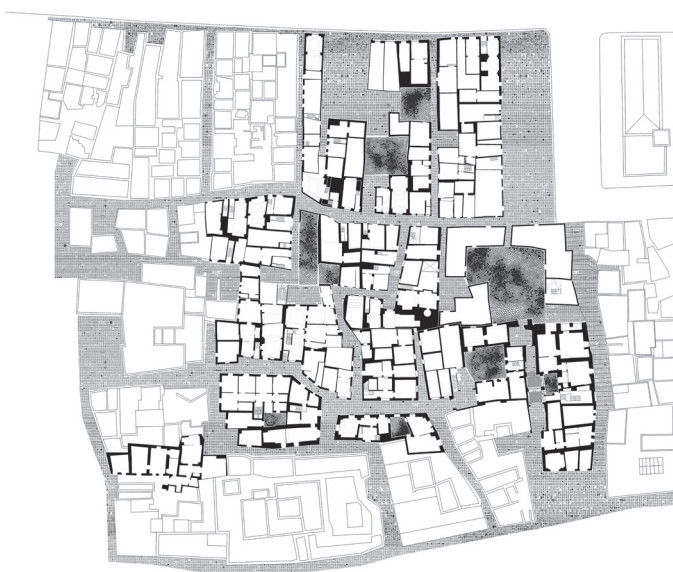
Fig. 4 - La planimetria dei piani terra dell'area di studio mostra l'aumento generale della penetrabilità al sito e la trasformazione di alcuni cortili in corti urbane per offrire alla città nuovi luoghi dello stare.
