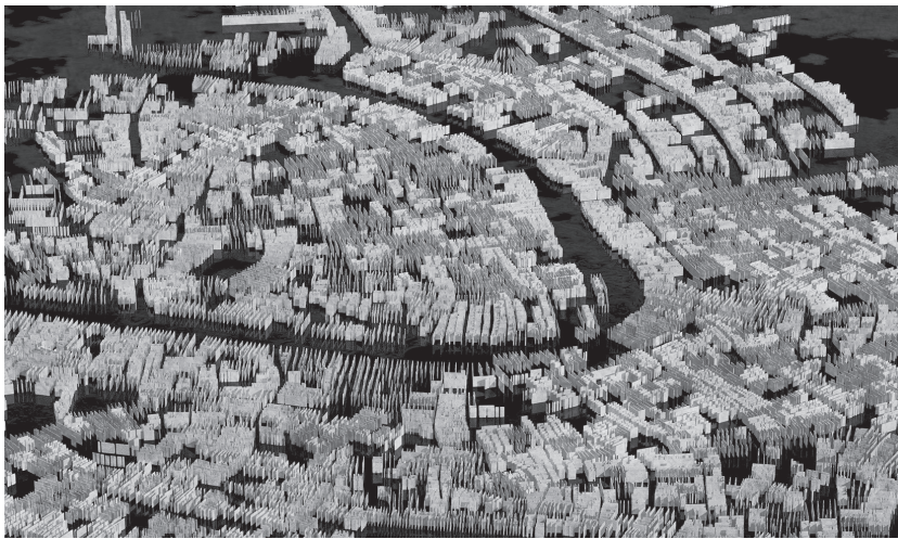
Fig. 3 - Vista assonometrica delle principali tecnologie costruttive veneziane rilevate a scala urbana: i piedritti o muri di spina, i pozzi e le cisterne sotterranee, i camini, le altane, in un unico disegno.
