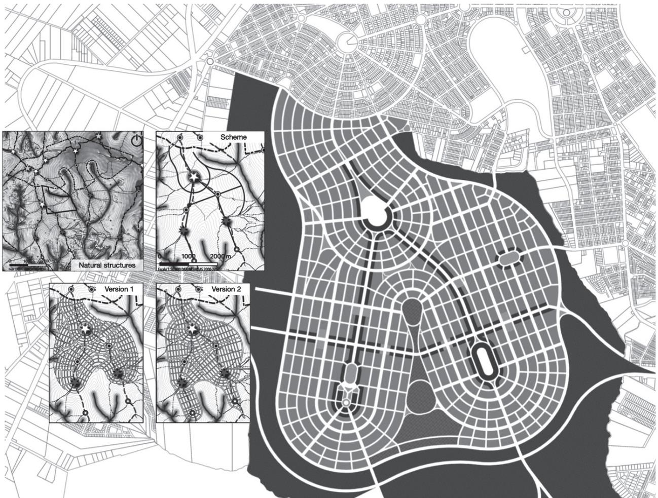
Fig. 2 - Fasi di progettazione del tracciato: dalla strutturazione naturale (sinistra) alle successive versioni basate su uno schema di strutture antropiche coerenti col sito; versione finale (destra) (elaborato dagli autori).
