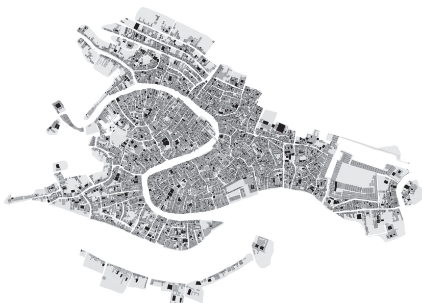
Fig. 2 - Mappa urbana delle principali tecnologie costruttive veneziane: pali/muri di spina, pozzi/cisterne, camini, altane, ecc., distribuite nel tessuto cittadino. Tale cartografia visualizza la diffusione capillare di questi dispositivi, evidenziandone la funzione di mappatura delle strategie costruttive proattive.
