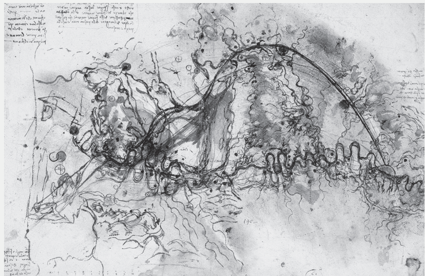
Fig. 3 - Studio preliminare per la deviazione dell'Arno attraverso Prato, Pistoia e Serravalle con un canale da Firenze a Vicopisano. Leonardo da Vinci, c. 1503.
