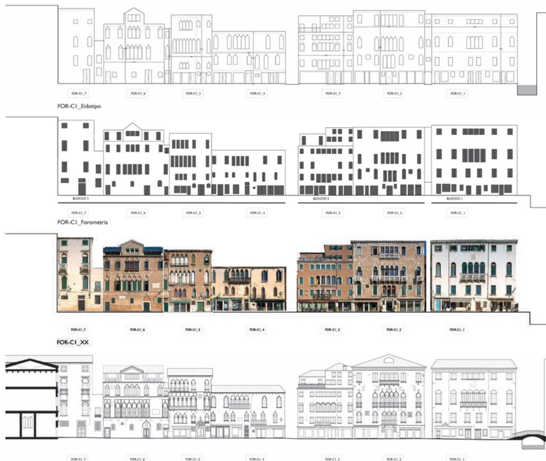
Fig. 4 - Il rilievo delle cortine urbane di S.M. Formosa in scala 1:500: a. Costruzione del modello geometrico/Eidotipo; b. Modalità di rilievo tramite scansione automatica (Laser scanner) o mosaicitura a seconda delle criticità/morfologia urbana; c. Esempio di restituzione grafica di una parte di cortina.
